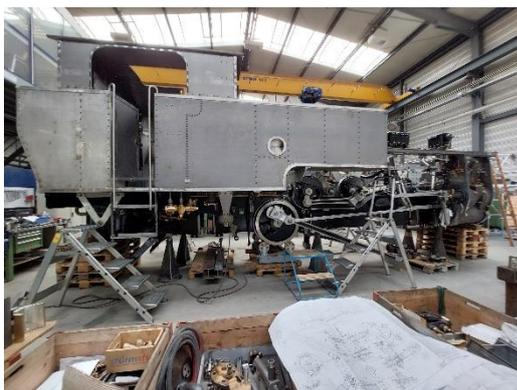
Rundumerneuerung der Dampflokomotive HG 4/4 Nr. 704 in der Dampflokomotivwerkstatt zu Uzwil in den Jahren 2006 bis 2018
